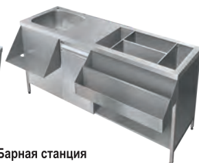
Барная станция 1600x500(700)x850мм/ цельнотянутая мойка 400x400x250мм, отв. под смеситель, рабочая столеш- ница, сварная ванна со съёмными перегородками (3 шт), 2 кармана для бутылок (съёмный и несъёмный), полки под блендер и для инвентаря, нок-бокс, откидной бункер для мусора
