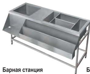
Барная станция 1500x500(700)x850мм/ сварная мойка 400x400x250мм, рабочая столешница, сварная ванна со съёмными перегород- ками (3 шт), 2 кармана для бутылок (съёмный и несъём- ный), полка под блендер
