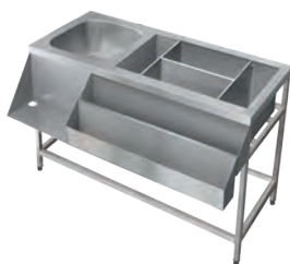
Барная станция 1250x500(700)x850мм/ моечная ванна цельнотянутая, сварная ванна с выпуском и съёмными перегородками (3 шт), карманы для бутылок (съёмный и несъёмный), полка под блендер
